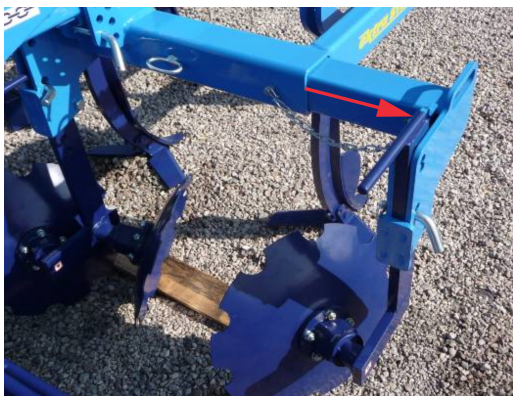
Рис.4 - задний двойной каток в рабочем положении
