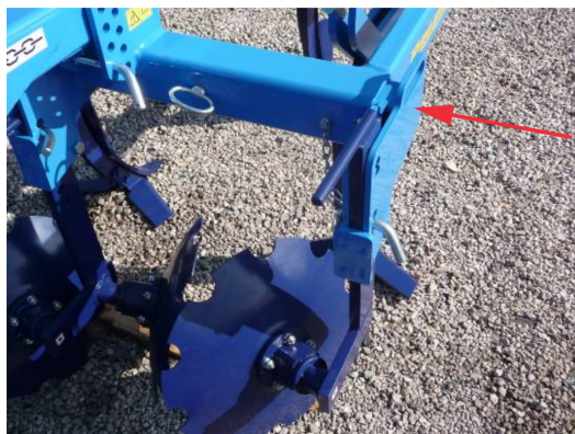
Рис.5 - задний двойной каток в трансп. положении
