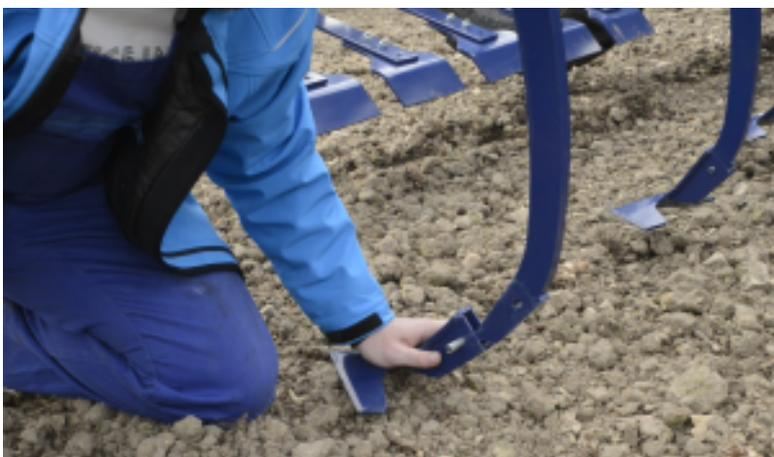
Enfoncer le nouvel outil de travail sur l'étauçon et le bloquer à l'aide de la goupille flexible 12x50 mm.
