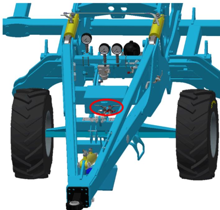
Pour déplier la machine dans le champ pressuriser le circuit rouge à 100 bar, il est nécessaire de commuter les robinets à trois voies sur le timon pour commander le système d'équilibrage de l'inclinaison avant-arrière :
