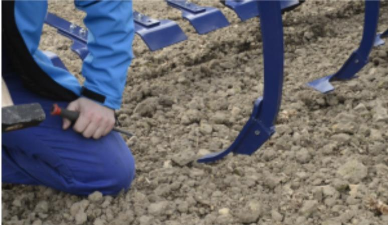
La machine est suffisamment sortie de terre, de façon à ce que l'organe de travail puisse être retiré de l'étauçon.
