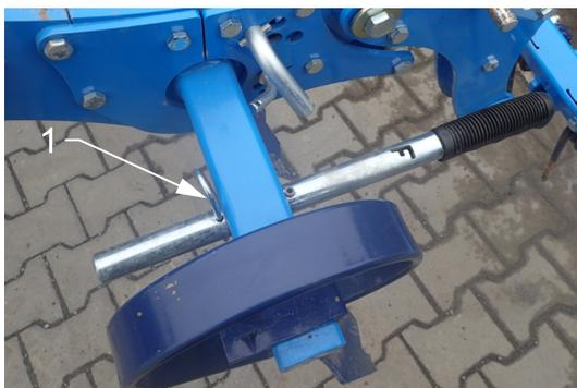
1 – Retirer la goupille flexible et retirer le levier du logement.
