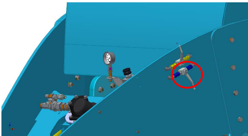
Obr. 30 – Uzavření ventilu sklápění
