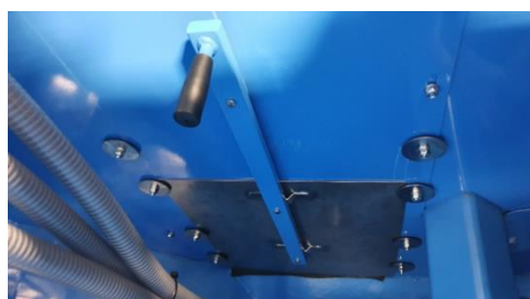
Dělicí stěna v zásobníku osiva
