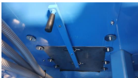
Dělicí stěna v zásobníku osiva
