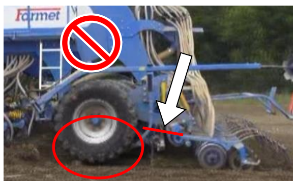
Obr. 58 – umístění manometru tlaku na secí orgány
