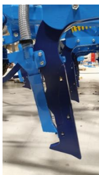
4.1.2 Nový tvar vyměnitelného dláta
